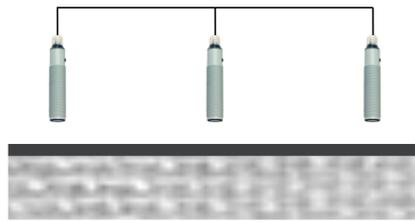
En este modo de trabajo todos los sensores miden simultáneamente. Todos los terminales de sincronismo (SYNC) tienen que estar conectados entre sí y el sistema debe estar alimentado. El producto a controlar debe ser plano y los sensores tienen que estar a la misma distancia. Esta es una condición obligatoria para el correcto funcionamiento de los sensores. Los sensores se han de ajustar individualmente antes de la conexión de sincronismo.
