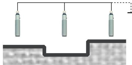
En este modo de trabajo los sensores miden en cadena. Todos los terminales de sincronismo (SYNC) tienen que estar conectados entre sí y también a masa (Vss). Alimentar el sistema y pasados 5 segundos desconectar SYNC de masa. Los sensores se han de ajustar individualmente antes de la conexión de multiplexado.
